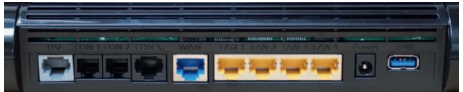
Voll bestückt: Mit DSL-Anschluss, einer digitalen (S0-) und zwei analogen Telefonbuchsen, einmal WAN (für externe Modems), viermal Gigabit-Ethernet und zweimal USB 3.0 (davon einer nicht sichtbar an der Geräteseite) sowie DECT- und WLAN-Funk lässt der Homeserver Speed+ keine Wünsche offen.
