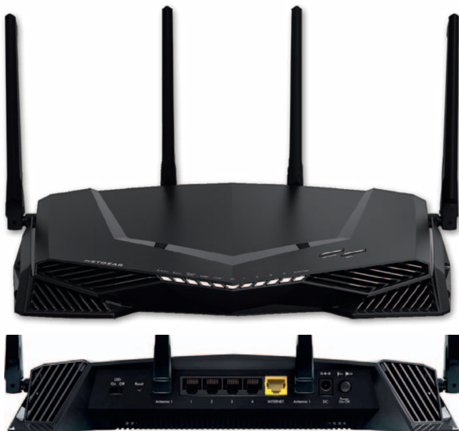
Konzentration aufs Wesentliche: Der XR500 speckt gegenüber dem XR700 vor allem bei der Hardware-Ausstattung ab. Geboten werden vier Gigabit-Ethernet-Ports, ein WAN-Anschluss und zwei (im Bild nicht sichtbare, weil an der rechten Geräteseite montierte) USB-3.0-Buchsen.
